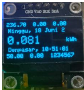
Gambar 6. Display OLED Saat Menampilkan Data Sensor
